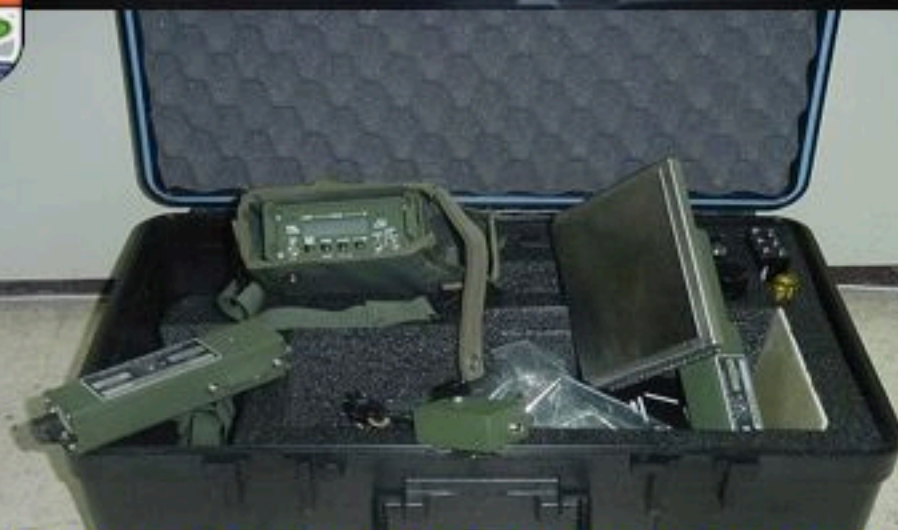
RADIÉMETRO —MIDE ONDAS ALFA, BETA Y GAMMA (RESIDUOS RADIATIVOS)
