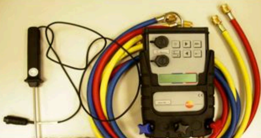
ANALIZADOR GASES REFRIGERANTES PERJUDICIALES CAPA OZONO
