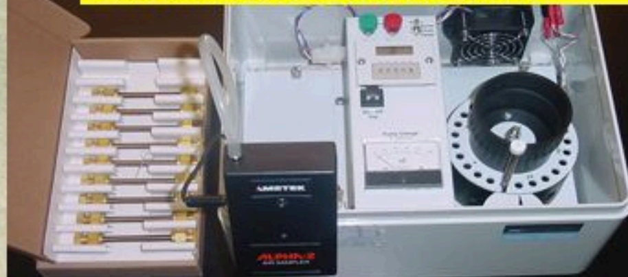
MUESTREADOR-CAPTADOR SECUENCIAL DE GASES —DETECCIÓN Y EVALUACIÓN COMPUESTOS ORGÉNICOS VOLÉTELES
