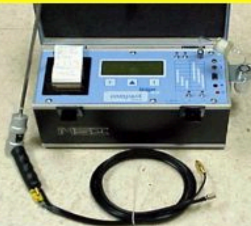
ANALIZADOR MSI COMPACT — CONCENTRACIONES GAS INDUSTRIA Y VEHICULOS
